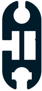
kederprofil 46/3 keder bead profile 46/3
