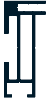
steckkederprofil 55/25 SEG profile 55/25
