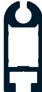
kederprofil 48/20 keder bead profile 48/20
